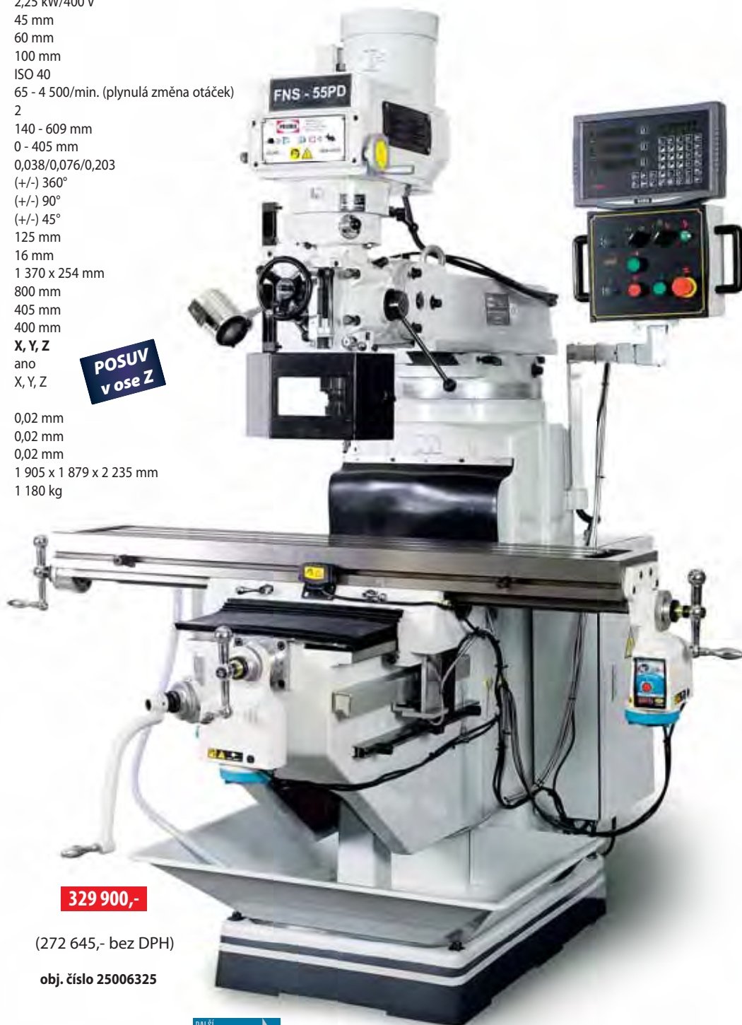
Strojní posuv s plynulou regulací a rychloposuvem
