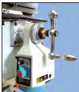
Strojní posuv s plynulou regulací a rychloposuvem
