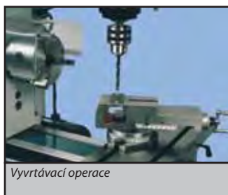
Odmontováním nožové hlavy máme k dispozici svěrák
