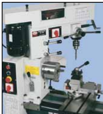
Frézovacím zařízením je možné otáčet
