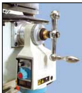
Strojní posuv s plynulou regulací a rychloposuvem
