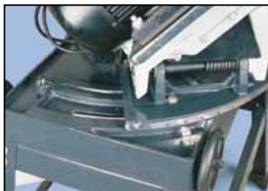
Natáčení ramene při řezání pod úhlem (PPK-115U)
