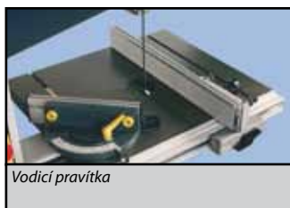
Pracovní stůl lze nastavit ručním kolem pod úhlem 0 - 45° (PP-350E)
