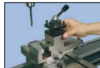
Odmontováním nožové hlavy máme k dispozici svěrák
