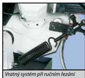
Vratný systém při ručním řezání
