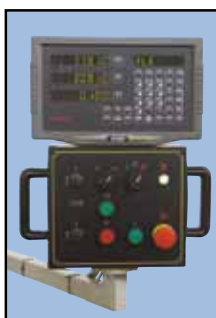
Displej digitálního odměrování osy X, Y, Z
