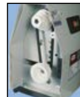
Převody stroje klínovým řemenem a čtyřstupňovými řemenicemi
