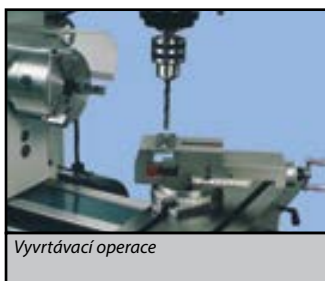
Odmontováním nožové hlavy máme k dispozici svěrák
