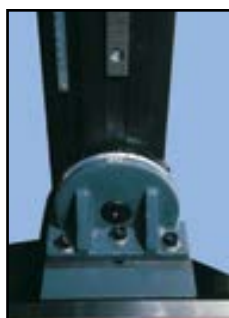
Frézku lze v podélné rovině stolu nastavit pod úhlem ± 45°
