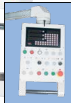
Ovládací panel s digitálním odměřováním s otočným ramenem.
