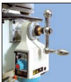
Strojní posuv s plynulou regulací a rychloposuvem
