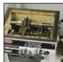
Všechny pohybující se součásti vřetenku SPA-500P jsou mazány olejovou lázní
