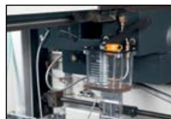
Stroj je vybaven manuálním centrálním mazáním.
