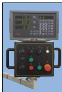
Displej digitálního odměřování osy X, Y, Z
