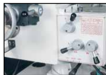
Převodová skříň pro posuvy a rychloposuvy os X, Y
