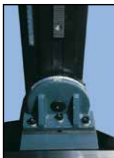
Frézku lze v podélné rovině stolu nastavit pod úhlem ± 45°
