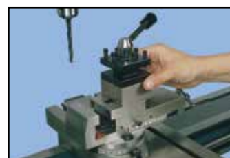
Odmontováním nožové hlavy máme k dispozici svěrák
